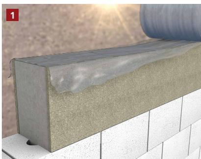
1 Die Schalung nach dem Betonieren mit der Folie abdecken.
