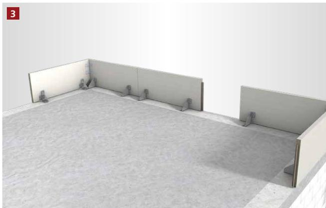
Anschließend werden die Elemente dazwischengesetzt und ebenfalls in der Betondecke verschraubt.
