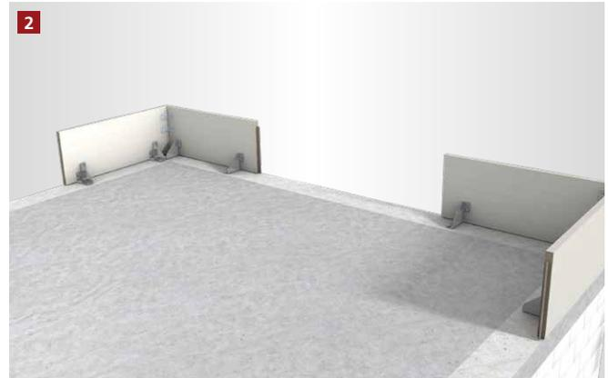
Die ersten Elemente werden im Bereich der Ecken aufgestellt und mit z.B. 10 x 90 mm Schrauben in der Betondecke befestigt. Zusätzlich werden die Elemente untereinander mit Winkeln verschraubt.
