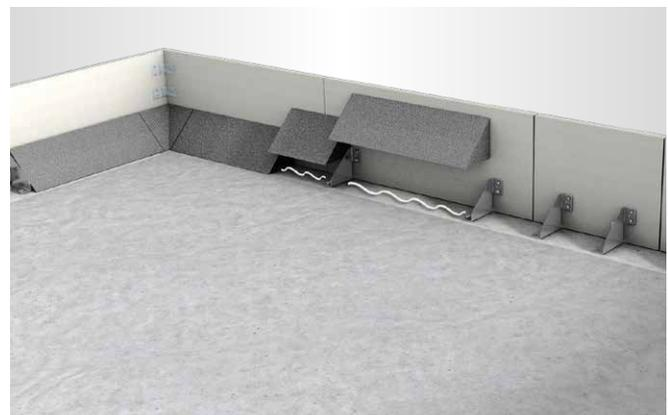
Optionale Dämmstoffkeile verhindern Kältebrücken und erleichtern die Abdichtung. Sie werden nach der Attika-Montage eingesetzt, verklebt und bauseits angepasst.
