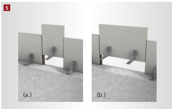
Je nach Länge des bauseits zugeschnittenen Elements, kann der Einbau ohne zweiten Winkel erfolgen (a.) oder mit bauseits versetzten zweiten Winkel (b.)
