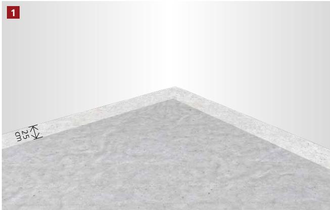
Die Betondecke wird im äußeren Bereich min. 25 cm breit plan abgezogen.
