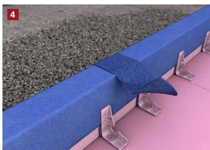
Anschließend werden die Elementstöße mit dem Stoßdichtband verklebt und die Fugen geschlossen.
