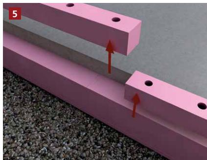
Bei Ausführung mit Absatzprofil: Das Absatzprofil wird am Folgetag entfernt.
