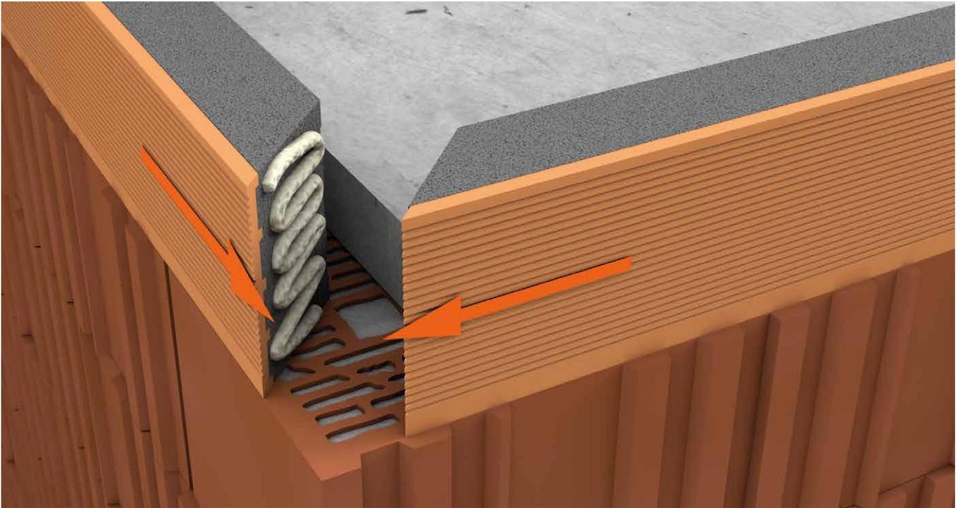
Für die Herstellung von Ecken kann die Deckenrandschalung Neo / Neo ZB / Neo ZR mit Handsäge oder Elektrofuchsschwanz auf Gehrung geschnitten werden. Anschließend werden die Stöße verklebt und voreinander gesetzt.
