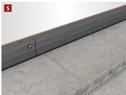
Als Rückverankerung wird die Speedschraube mit Fixieröse\*\* in das Kombielement geschraubt und mit Rödeldraht eine Rückverankerung zum Bewehrungsgitterträger geschaffen.
