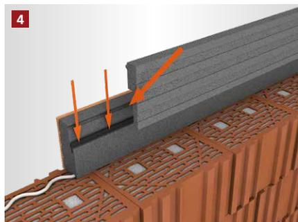
Die Steckfeder wird im äußeren Schenkel eingesetzt. Anschließend wird der innere Schenkel stoßübergreifend auf das äußere Element aufgesetzt.
