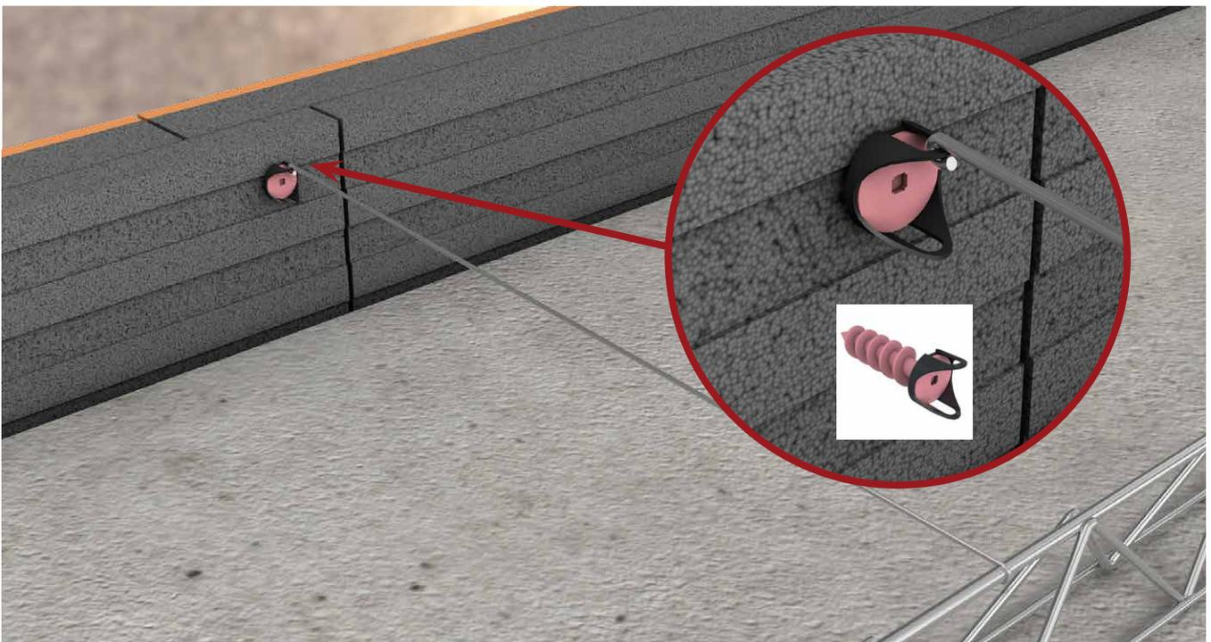
Eine Speedschraube (80 mm) mit Fixieröse\* wird in die Deckenrandschalung Neo / Neo ZB / Neo ZR geschraubt. Mit Rödeldraht wird eine Rückverankerung zum Bewehrungsgitterträger geschaffen.
