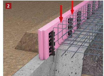
Die Bewehrung für die Bodenplatte wird eingesetzt und die FSA Easy Schalung an den Stabstahlhaltern in Richtung der Bewehrung abgespannt. Nach Bedarf kann die Schalung von außen angefüllt werden.
