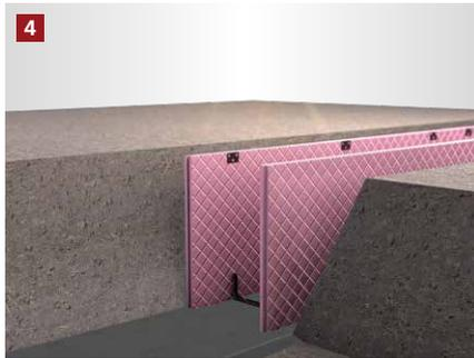
Die Fundamentschalung wird in den Graben eingestellt.
