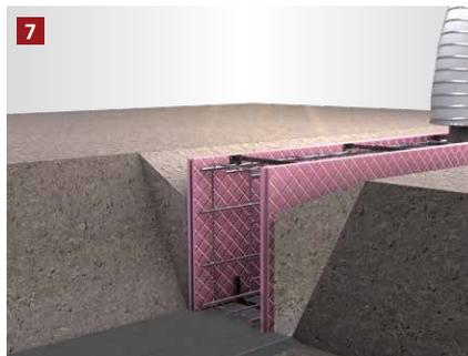
Der Betonvorgang kann im Anschluss direkt begonnen werden.
