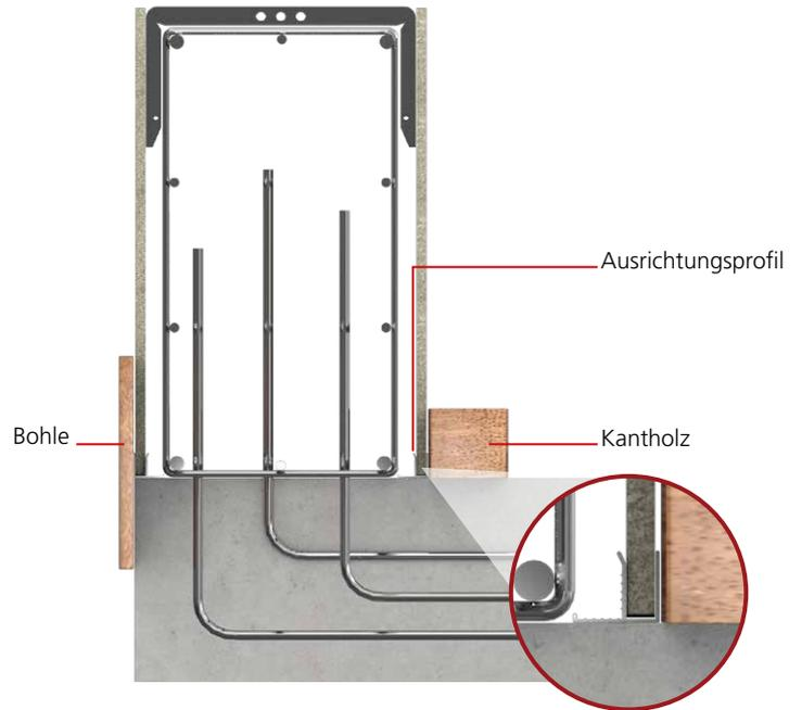
Die rekord MBA® Attika Schalung wird bei allen Bauten mit einer Attikaaufrichtung (z. B. bei Flachdächern) genutzt. Das Schalungselement wird mit der Schalungsöffnung nach unten auf dem Mauerwerk aufgestellt. Alternativ kann die MBA® Attika Schalung mit Original rekord PU-Schaum aufgeklebt oder gemörtelt werden.
