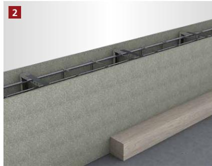
Anschließend muss die Schalung zusätzlich bauseitig abgestützt werden, z.B. mit Hilfe eines Kantholzes und einer Bohle.
