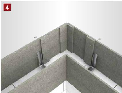
Das Element wird durch Verschraubung fest mit der Ringbalkenschalung verbunden.
