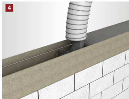
Der Betoniervorgang kann begonnen werden.
