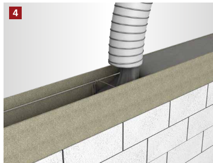
Der Betoniervorgang kann begonnen werden.
