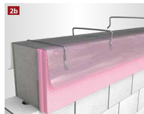
Die Folie auf der gedämmten Schalung mit den rekord Befestigungsbügeln befestigen bis der Beton vollständig ausgehärtet ist.
