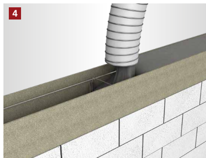
Der Betoniervorgang kann begonnen werden.
