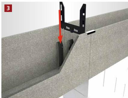
Der Bewehrungskorbpositionierer wird in die MBA® Schalung eingesetzt.
