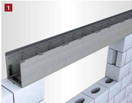
1. Die MBA® Sturzschalung wird eingebaut. Auf dem Außenschenkel wird das Erhöhungprofil befestigt und auf dem Innenschenkel der HB Top-Verbinder. Aussteifung der Schalung mittels Ankerdraht.
